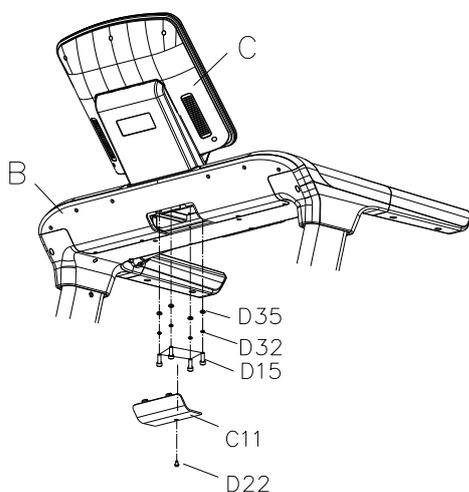
1. Закрепите консоль C на опорной раме B с помощью 4 болтов M8x15 D15, 4 пружинных шайб D32, 4 плоских шайб D35 и внутреннего шестигранного ключа B09.
