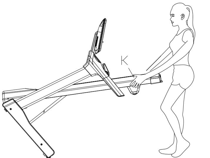
Для транспортировки удерживайте беговую дорожку в положении "К" и наклоняйте до тех пор, пока колеса не смогут двигаться по полу.
