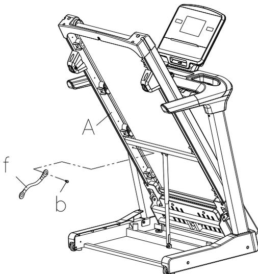
1. Открутите болт M8\*15 (b) с верхней части рамы (f) с помощью шестигранного ключа B10 #5. Затем уберите стальную пластину с нижней части рамы.
