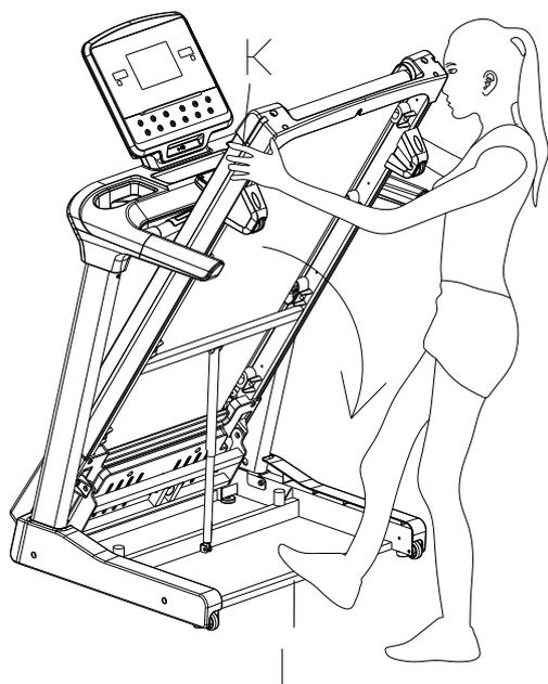
Для того чтобы наклонить тренажер, возьмитесь одной рукой за нижнюю часть рамы "К", чтобы поддерживать верхний конец беговой дорожки. Затем поставьте ногу на планку "L", чтобы удерживать нижний конец беговой дорожки. Теперь медленно наклоняйте верхнюю часть беговой дорожки вниз к полу. Как только рама "К" достигнет достаточно низкой точки, транспортировочные колеса беговой дорожки начнут двигаться.
