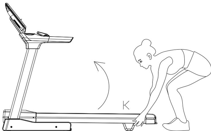
Возьмитесь за нижнюю часть рамы, показанную в положении "К", а затем складывайте беговую дорожку в направлении стрелки до тех пор, пока не услышите щелчок.
