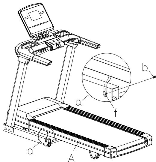
1. Открутите болт M8\*15 (b) с нижней стороны рамы (f) с помощью шестигранного ключа B10 #5.
