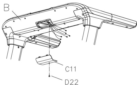
1. Снимите кожух консоли C11 с помощью торцевого ключа B08.
