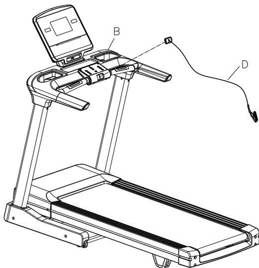
1. Установите ключ безопасности D на место на консоли и закрепите конец ключа на одежде.
