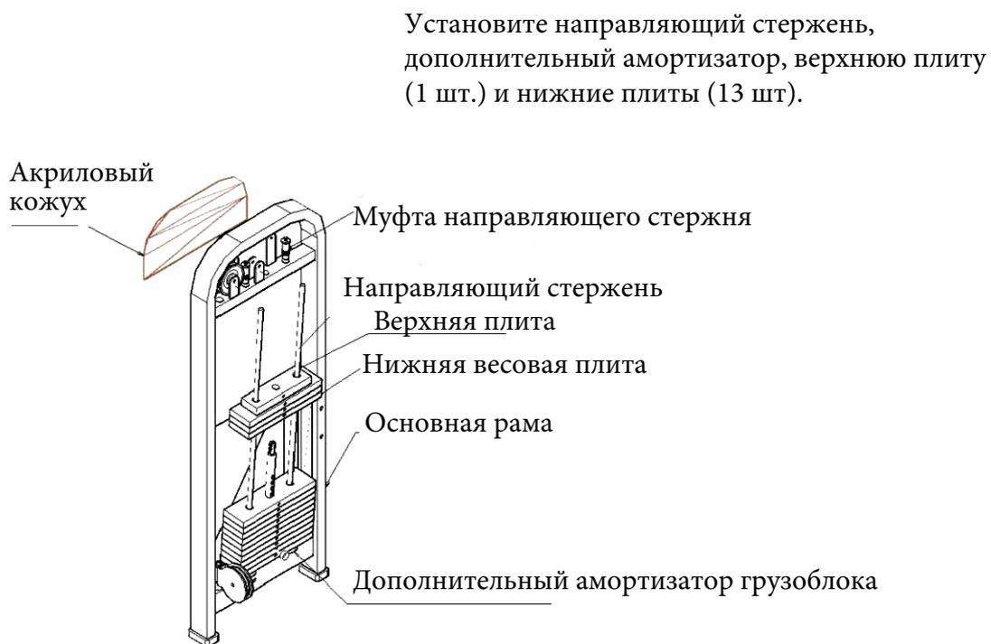
Установите направляющий стержень, дополнительный амортизатор, верхнюю плиту (1 шт.) и нижние плиты (13 шт.).
