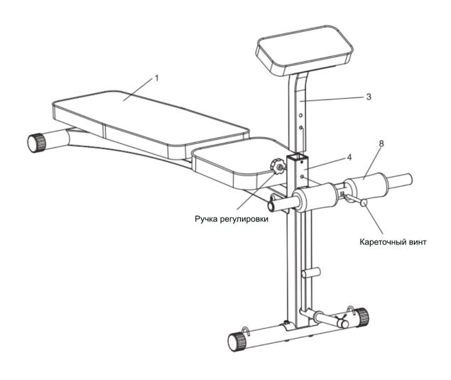
Шаг 5 Вставьте опору платформы #3 в основную раму #1, как показано на рисунке. Ослабьте ручку регулировки на поручне #8 и с помощью кареточного винта присоедините поручень #8 одновременно к передней опоре #4 и опоре платформы #3, после чего закрутите обратно ручку регулировки.
