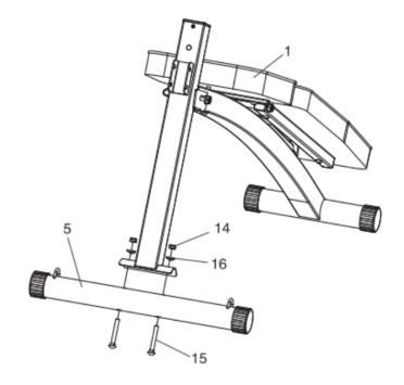
Шаг 2 Закрепите опору подножки #5 на основной раме #1, используя 2 контргайки М8, 2 дуговые шайбы Ф8 и 2 шестигранных винта М10х60 с плоской головкой, после чего с помощью гаечного ключа 13-17 затяните гайку по часовой стрелке.
