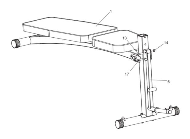
Шаг 3 Закрепите раму подножки #6 на основной раме #1, используя один шестигранный винт М8х45 с плоской головкой и одну контргайку М8, после чего с помощью шестигранного ключа №6 и гаечного ключа 13-17 затяните гайку по часовой стрелке. Наконец, вставьте короткий штифт Ф8 #17 в отверстие на основной раме, показанное на рисунке.
