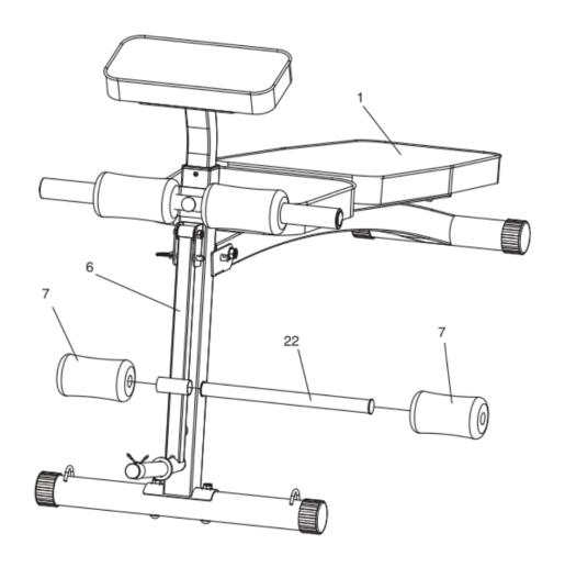
Шаг 6 Вставив опору для накладок #22 в отверстие на раме подножки #6, установите с обоих концов мягкие накладки #7.
