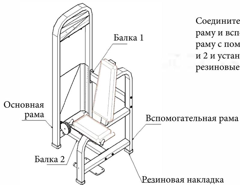
Соедините основную раму и вспомогательную раму с помощью балок 1 и 2 и установите резиновые накладки.
