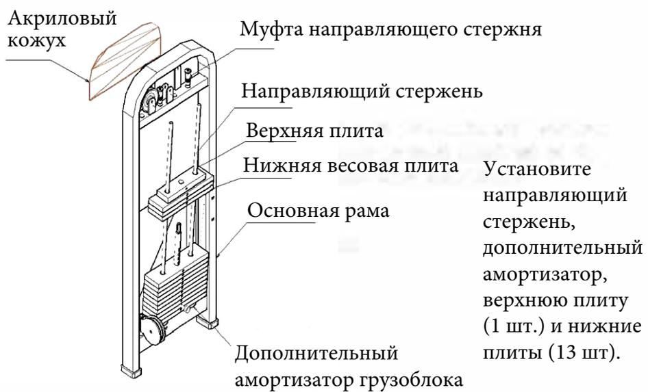
Установите направляющий стержень, дополнительный амортизатор, верхнюю плиту (1 шт.) и нижние плиты (13 шт.).
