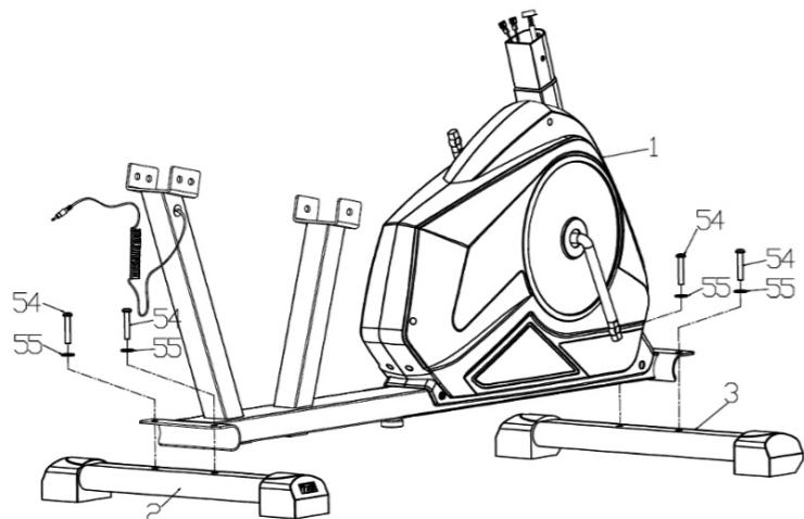
Осторожно прикрепите задний стабилизатор (2) к основной раме (1) с помощью винтов (54) и шайб (55).
