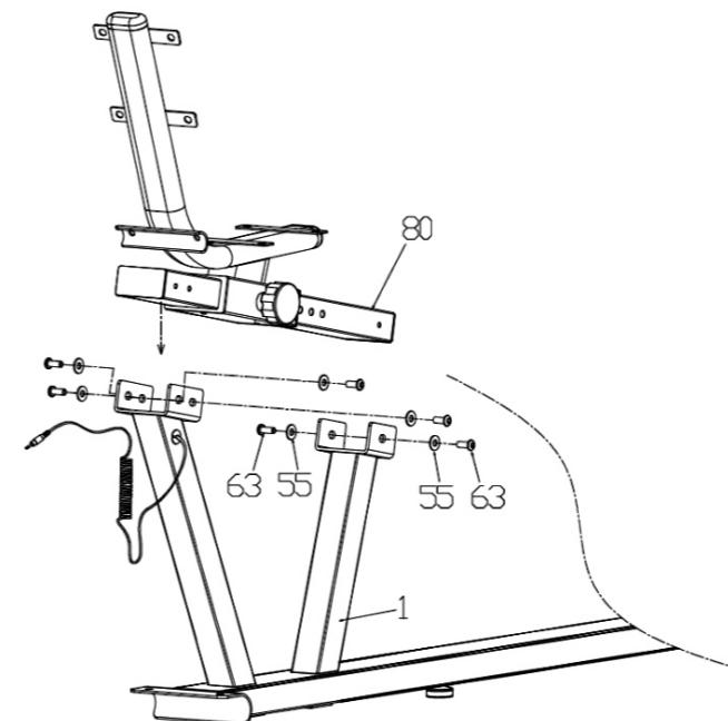
Прикрепите подседельную трубку (80) к основной раме (1) с помощью винтов (63), шайб (55) и нейлоновых гаек (66).
