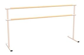
Опоры станка выполнены из стальных стоек 25 х 50 х 2 мм, утяжеленных металлическими гранулами. Материал для перекладин отбирается из древесины высшего сорта (береза и бук) без сучков, покрывается полимерным экологически чистым двухкомпонентным лаком. При сборке конструкции перепад между внутренним диаметром металлической части и деревянной перекладиной не более 2 мм.
