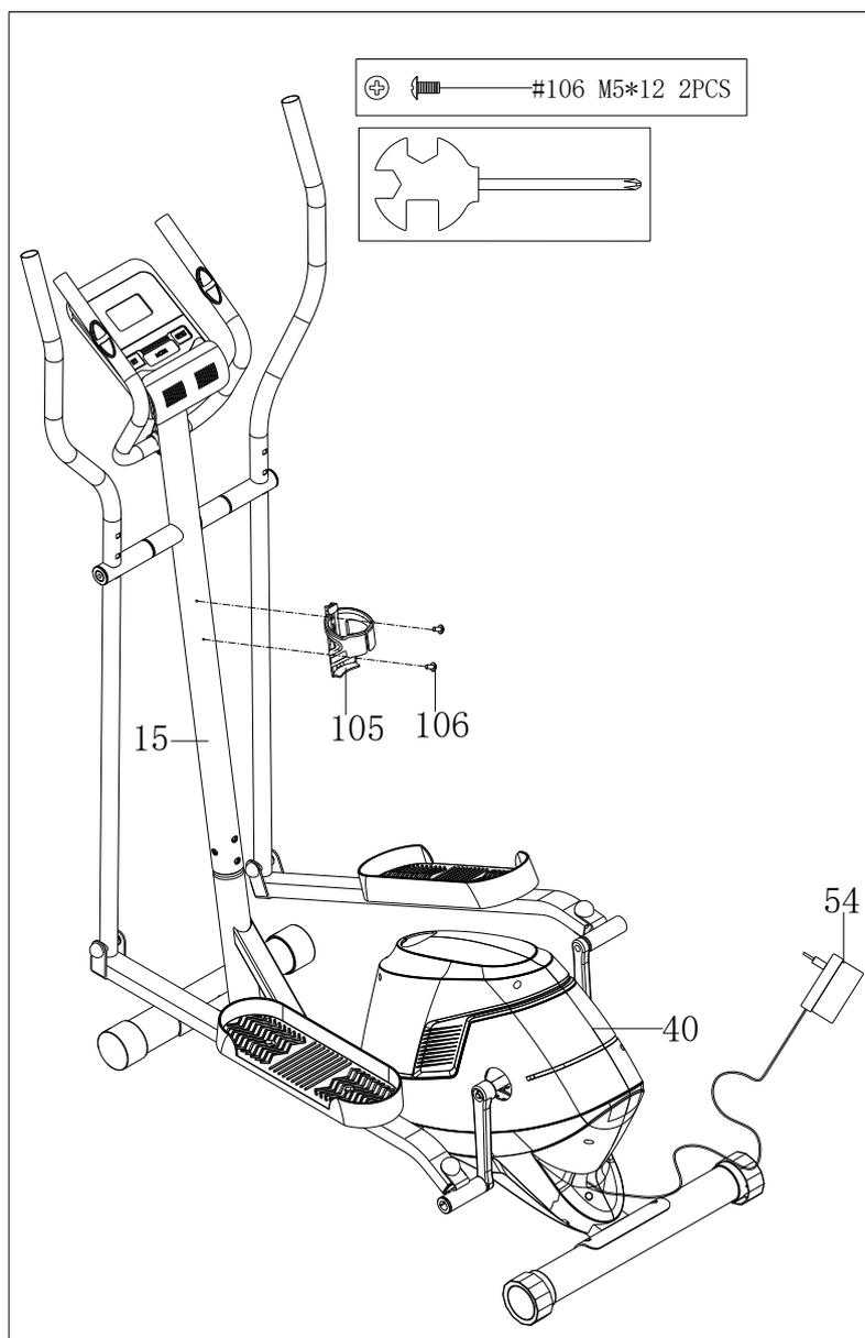
1. Прикрепите держатель для бутылки (105) к опорной трубке (15) винтом (106).
