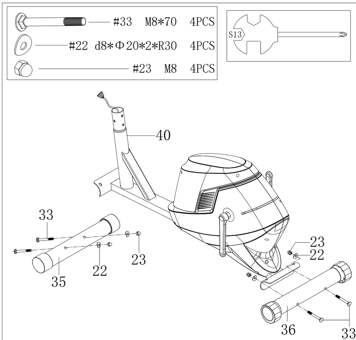
а. Прикрепите передний стабилизатор (35) и задний стабилизатор (36) к главной раме (40) с помощью болта (33), дуговой шайбы (22) и гайки (23).
